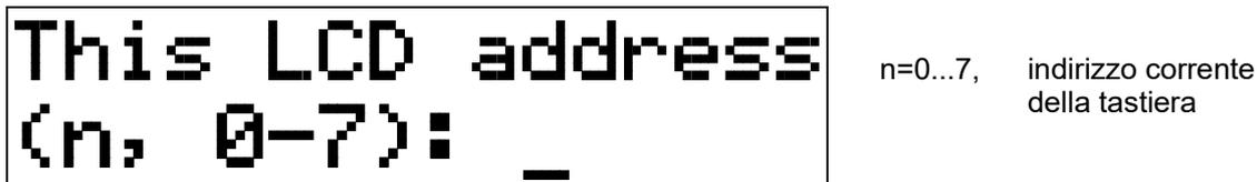
Fig. 6. Programmazione dell'indirizzo della tastiera LCD con la funzione di programmazione.
